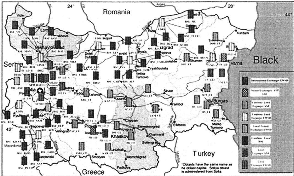
Схема на основните комутируеми точки (телефонни централи) в мрежата на БТК ЕАД
